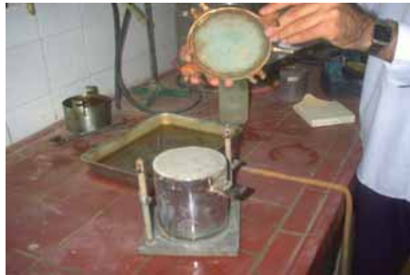
شکل (۵) : بستن انتهای نمونه با صفحه متخلخل
