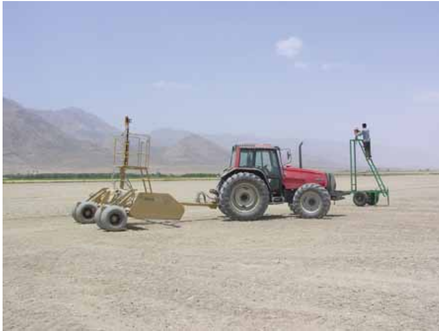
نگاره ۵- نمای مجموعه باکت تسطیح و تراکتور.
