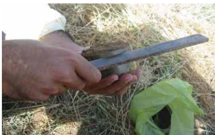
شکل (۴): نحوه صاف کردن دو طرف نمونه خاک
