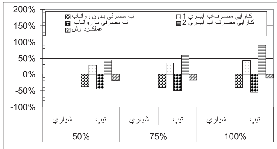
شکل ۳: درصد تغییرات آب مصرفی و کارایی مصرف آب در روش آبیاری تیپ در مقایسه با روش شیاری در تیمارهای مختلف مقدار آب آبیاری (میانگین دو سال).
