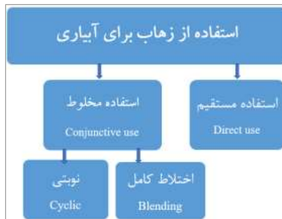
شکل ۱۱-۳- روش‌های متداول استفاده دوباره از زهاب
