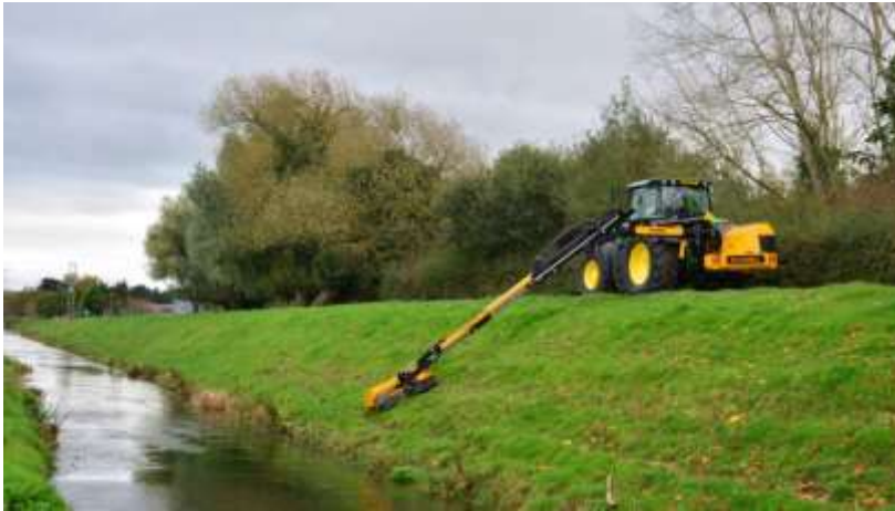
شکل ۱۱-۱۱- روش درست جایگزین لایروبی زهکش‌های روباز
