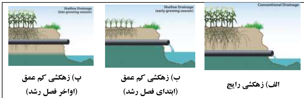
شکل ۱۱-۱- اثر کاهش عمق نصب زهکش های زیرزمینی بر فرآیند تخلیه زهاب
