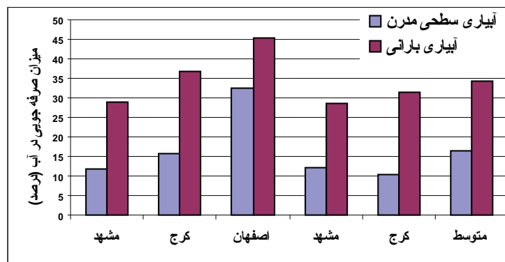
شکل ۱- میزان صرفه‌جویی در مصرف آب در روش‌های آبیاری سطحی مدرن و بارانی نسبت به روش آبیاری سطحی سنتی
