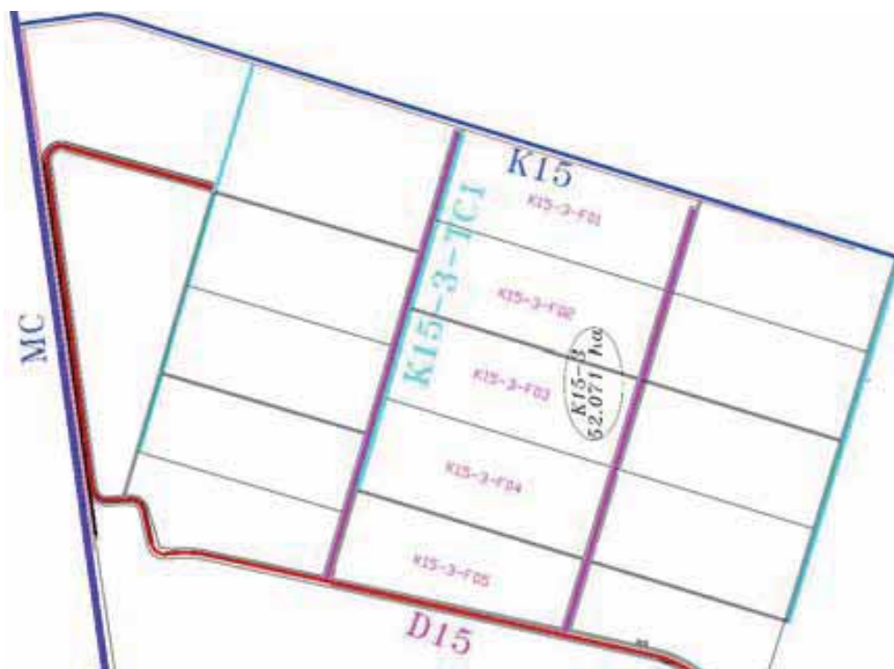
شکل (۱-۶): طرح و جانمایی شبکه اصلی و فرعی آبیاری و زهکشی
