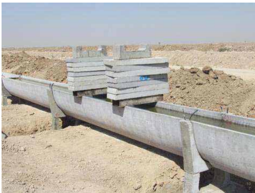
شکل (۳-۸): آزمایش خمش طولی
