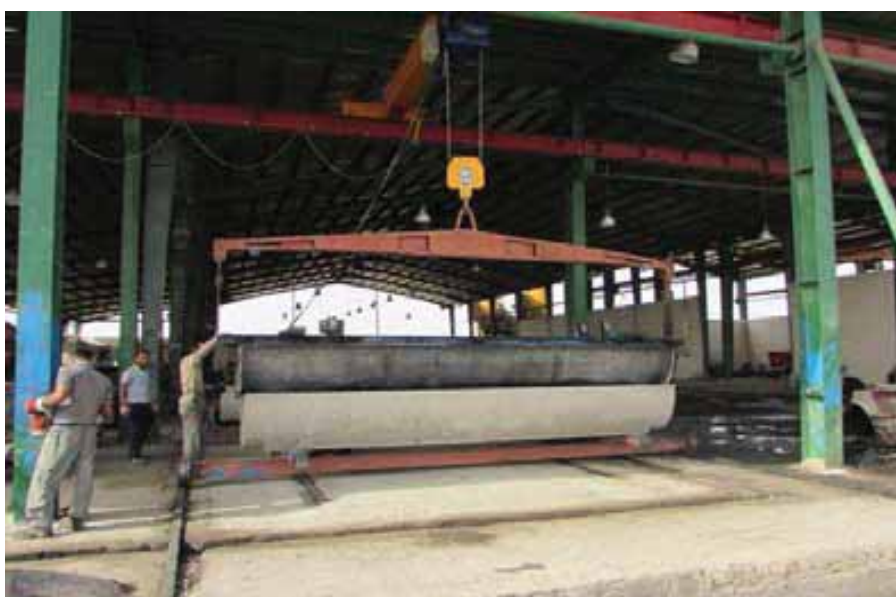
شکل (۳-۵): باز کردن قالب کانالت و هدایت آن به سمت استخر با کمک ریل
