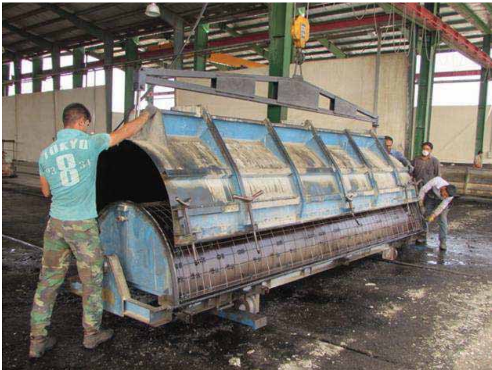
شکل (۲-۷): قالب استفاده شده در کانالت
