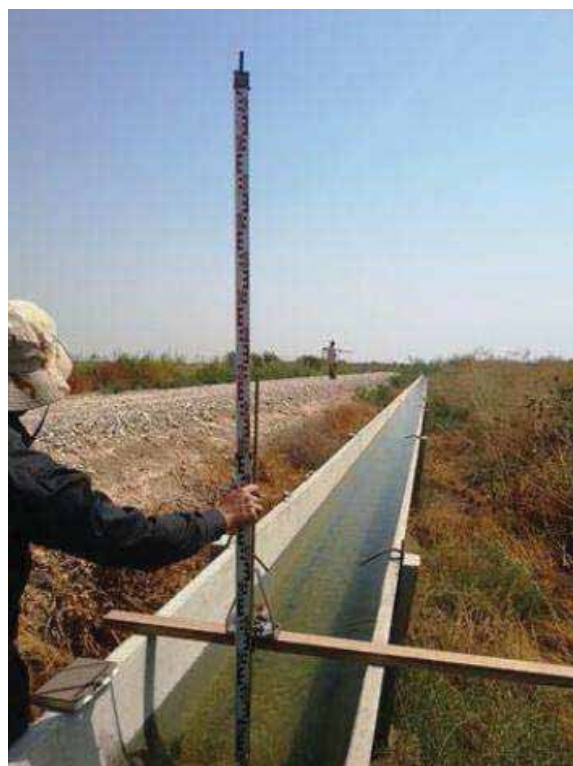
شکل (۳-۱۰): تعیین شیب کف توسط دوربین نیوو
