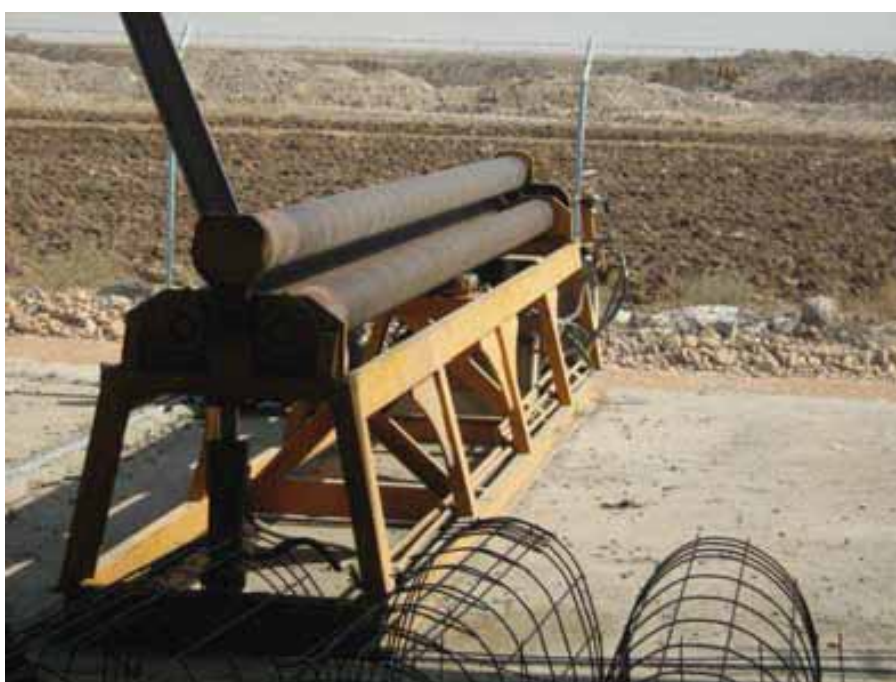
شکل (۳-۲): دستگاه نورد شبکه میلگرد پیش جوش
