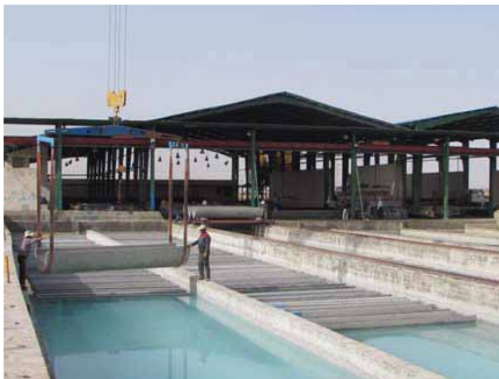
شکل (۳-۶): بارگیری کانالت و عدم رعایت فاصله کمربندها از لبه
