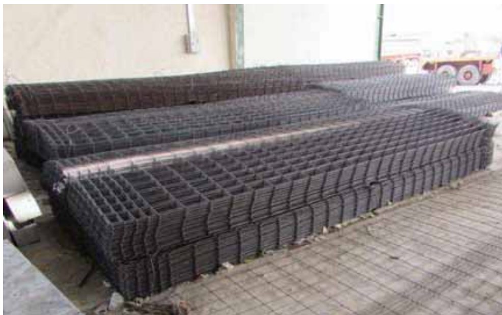
شکل (۲-۵) شبکه میلگرد جوش شده (مش)
