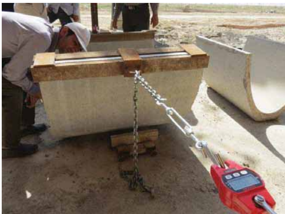
شکل (۳-۹): آزمایش خمش عرضی و کنترل نمونه
