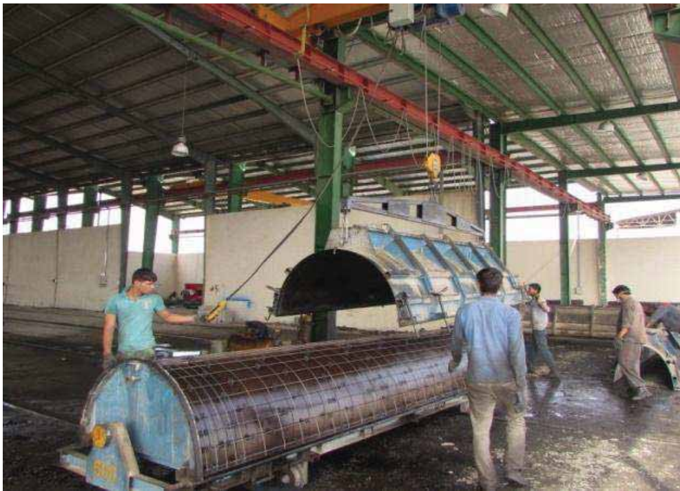
شکل (۳-۳): آرایش فاصله انداز ها بر روی شبکه قبل از بستن قالب بیرونی
