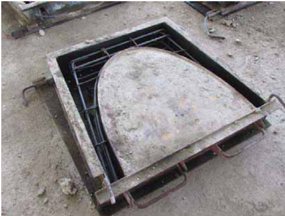
شکل (۲-۶): میلگردهای قرار داده‌شده در قالب زین
