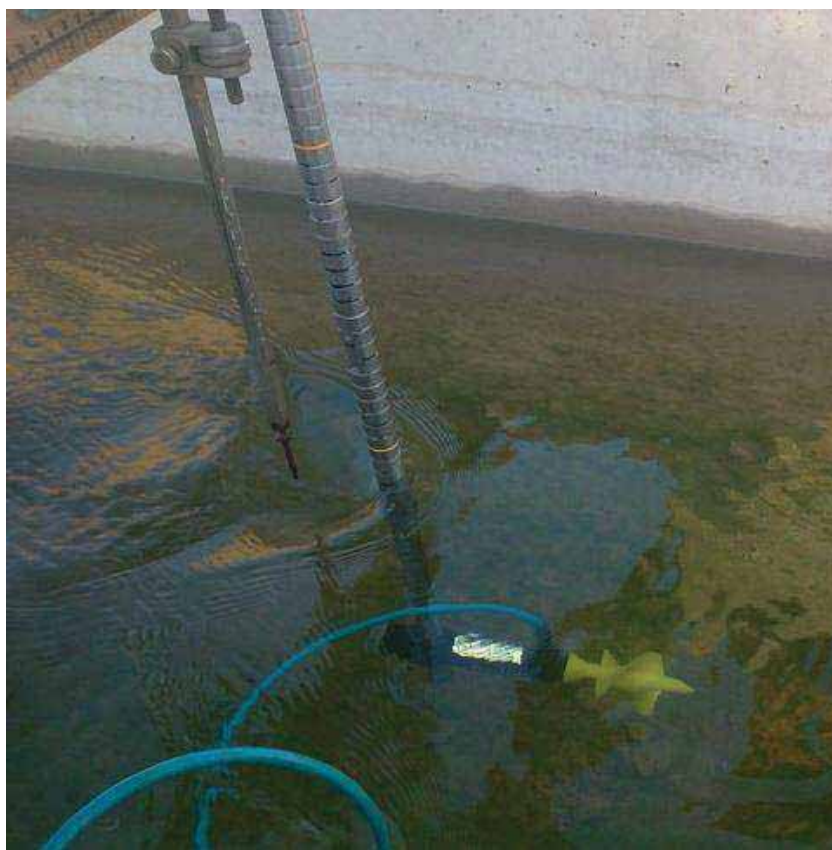
شکل (۳-۱۲): اندازه‌گیری سرعت جریان با استفاده از مولینه
