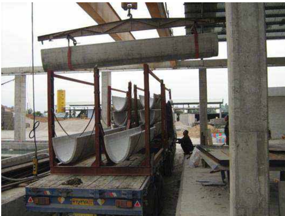
شکل (۳-۷): بارگیری و حمل کانالت به وسیله شاهین
