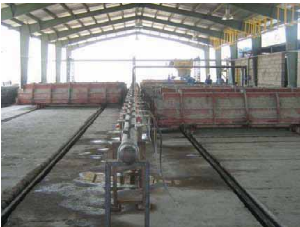
شکل (۲-۳): عمل آوری کانالت‌ها به وسیله بخار آب
