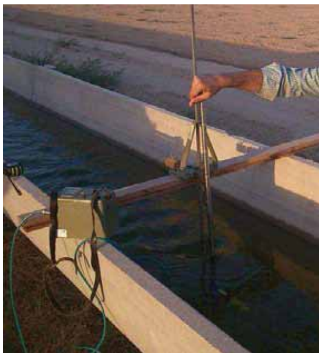
شکل (۱۱-۳): اندازه‌گیری عمق جریان با استفاده از پوینت گیج
