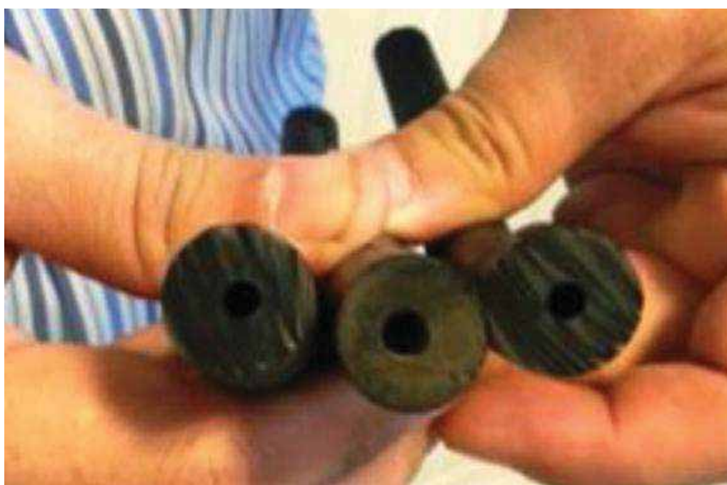
شکل (۲-۸): واشرهای آببندی و تکیه‌گاهی نیم‌لوله‌ها
