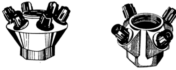
شکل شماره ۳۳- دو نوع فشارشکن ۴ و ۶ واحدی که در آبیاری قطره‌ای و میکرو برای تنظیم فشار جریان آب ورودی به مانیفولد کاربرد دارند.
