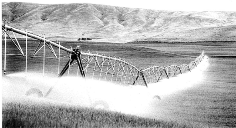
شکل شماره ۱۲- دستگاه بارانی دوار مرکزی (CENTER PIVOT)
