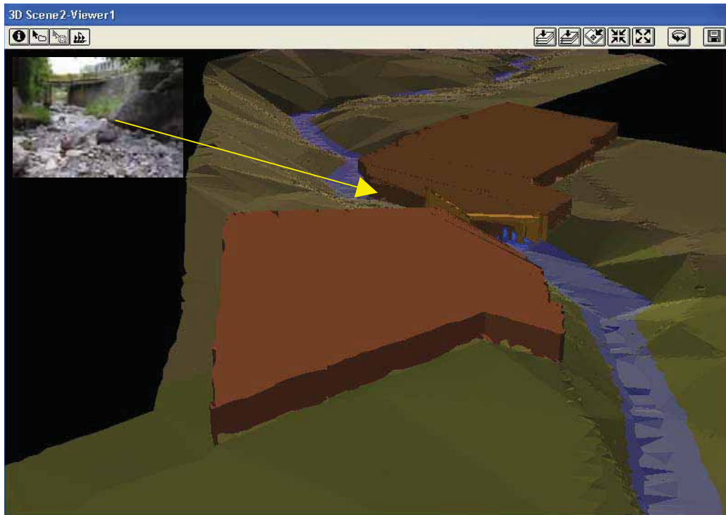
شکل ۱۰: نمایش سه بعدی پهنه سیلاب در محیط GIS با در نظر گرفتن لایه سازه‌های عرضی (پل) و ساختمان‌های موجود در حاشیه رودخانه
