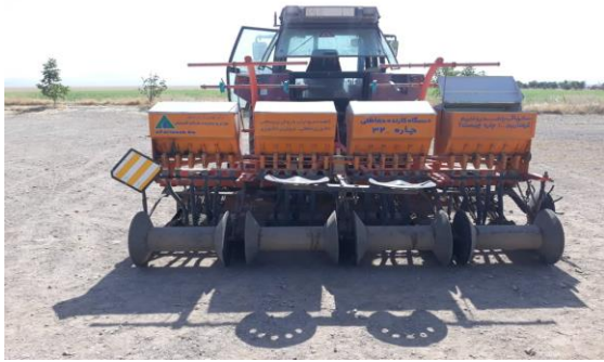
دستگاه کاشت بذر و نصب لوله آبیاری زیرسطحی
