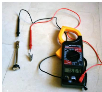
شکل ۱- ابزار اندازه‌گیری نوسانات سطح آب زیرزمینی در پیزومتر
