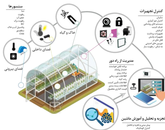
شکل ۳- اجزای گلخانه هوشمند مبتنی بر اینترنت اشیا
