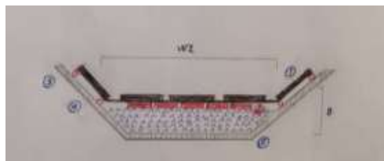
شکل ۴- شناور ماندن پلاتفرم روی سطح آب، بال دو طرف قابل انعطاف
