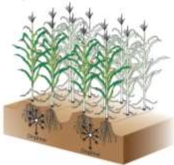
لوله قطره‌ای نصب شده در زیر سطح زمین
