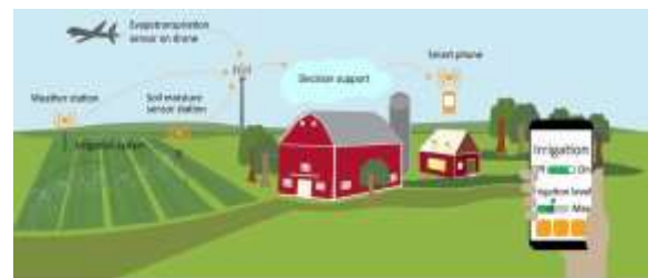
نمونه‌ای از یک سامانه آبیاری کاملاً هوشمند مبتنی بر اینترنت اشیا؛ از خانه تا مزرعه
