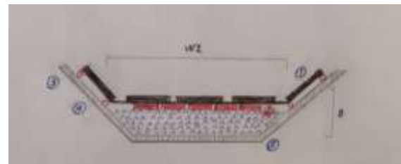
شکل ۴- شناور ماندن پلاتفرم روی سطح آب، بال دو طرف قابل انعطاف
