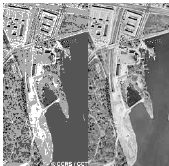
شکل ۹: اهمیت قدرت تفکیک رادیومتریک از طریق مقایسه تصویر ۲ بیتی در مقابل ۸ بیتی
