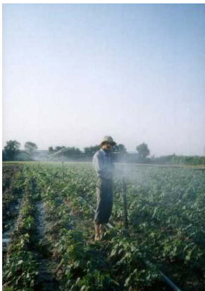
اندازه گیری فشار سرآبپاش‌ها توسط فشار سنج پیتو
