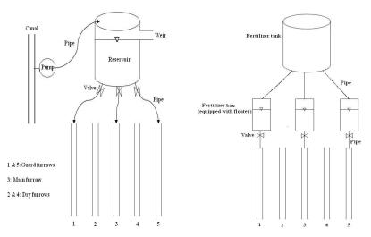
Fig. 1. Schematic of water distribution and fertilizer solution injection systems for FFI (Schéma de distribution d'eau et d'engrais solution systèmes d'injection pour FFI)
