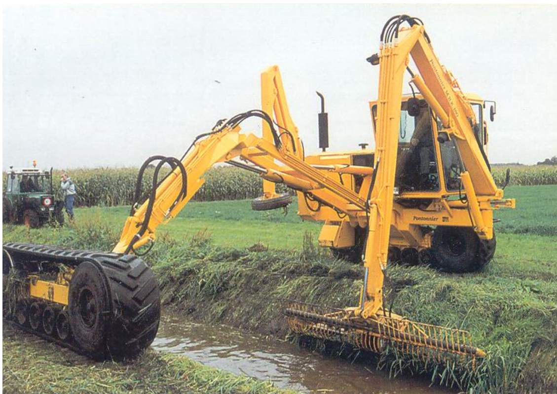
عکس (۱) پاک‌سازی علف‌های هرز در مسیر زهکش‌های سطحی بوسیله دستگاه علف‌بر
