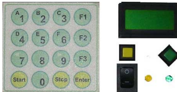
شکل ۲- صفحه نمایش، صفحه کلید، کلید روشن و خاموش و سایر اجزا رابط کاربر
