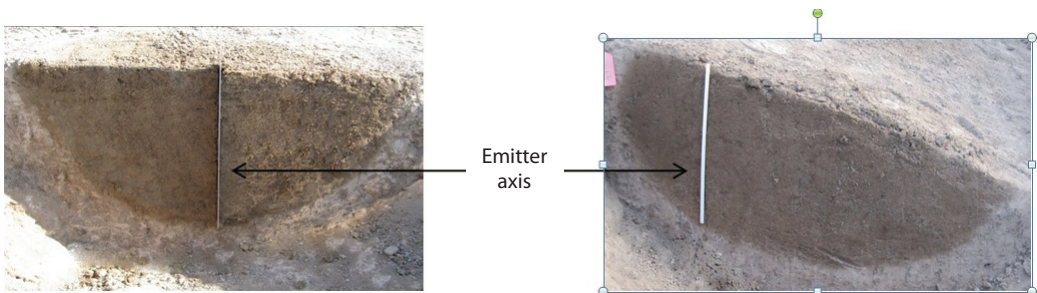
Fig. 2. The wetting pattern on 0% slope after 2 hours irrigation (Le bulbe humide sur une pente de 0% pour une durée d'irrigation de 2 heures)
