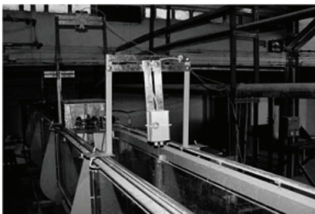
Fig. 1. Laboratory flume, depth and gate opening sensors, motor, and slide gate (Canal de laboratoire, profondeur et détecteurs d'ouverture de la porte, moteur, porte coulissante et)
